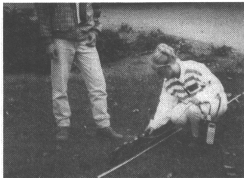
Foto: Een studente werkt met het EM-31 apparaat.
